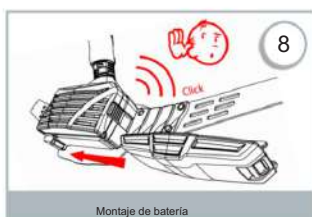
Montaje de batería
