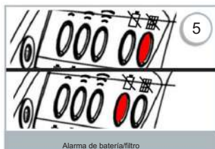
Alarma de batería/filtro
