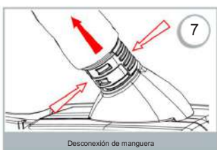
Desconexión de manguera
