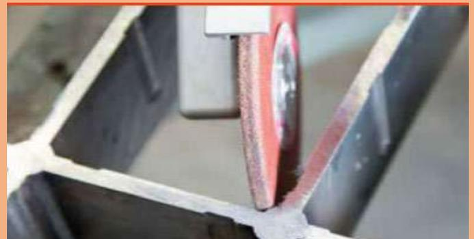
Desbaste agresivo con rápida eliminación y controlada del material.
