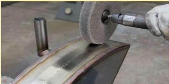
Eliminación de la decoloración de la soldadura, barniz y recubrimientos; estructuración.
